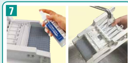
①コンベアのグレーのゴム部分に除菌スプレーをします。②多めの流水で十分に洗い流します。
