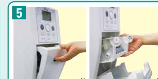
①前面カバーを手前に引き、②コンベアユニットを取り出します。
